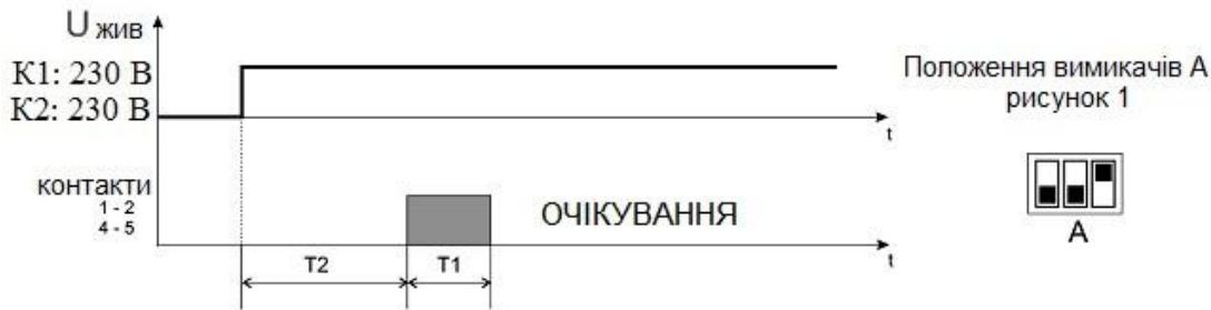
Рисунок 3 – Алгоритм роботи реле «Імпульсний 1»
