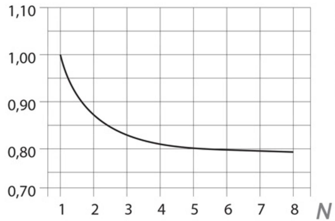
Зависимость номинального тока автоматического выключателя от количества установленных рядом выключателей
