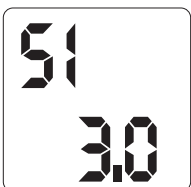
Якщо несправність надмірного струму триває 3 с, вихідне навантаження вимикається
