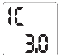
Зона спрацювання від перевантаження (межа чистого резистивного навантаження) 3 А
